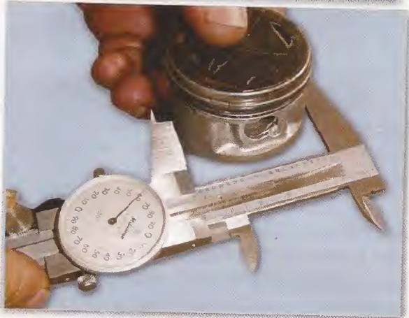
Verificación de la tolerancia pistón - cilindro
